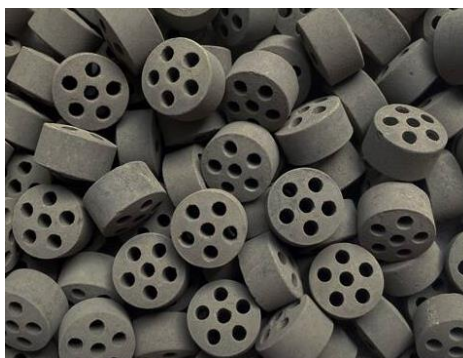
Rys. 4 Fotografia komercyjnego katalizatora niklowego reformingu parowego HyKat SR-211 firmy Chempack, źródło: https://chempack.co/product/hykat-sr-211/
