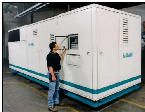
Elektrownia kogeneracyjna rozproszona o mocy 250 kW lata 90-te
