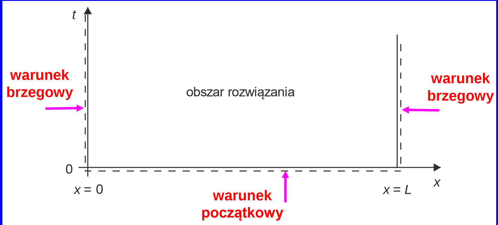
Rys. Obszar rozwiązania równania dyfuzji: 0 \leq x \leq L oraz t \geq 0
