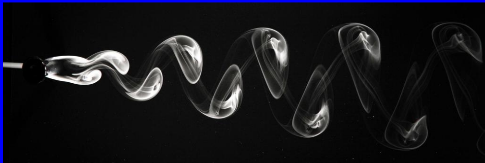
Wizualizacja ścieżki wirów generowanych przez kołowy cylinder
