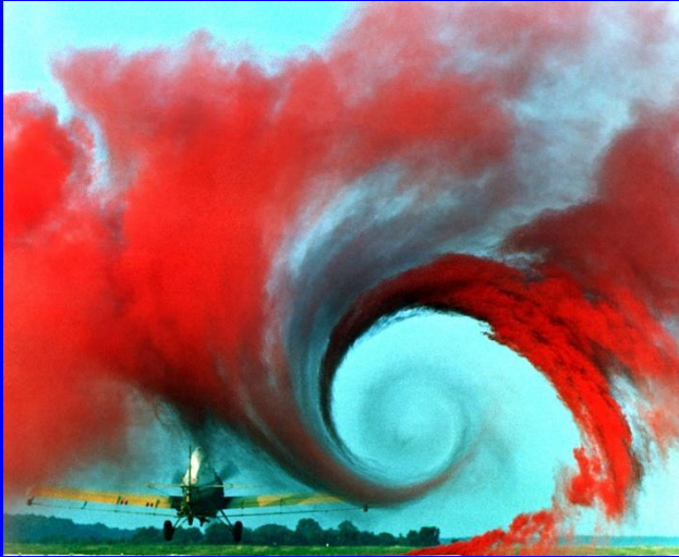
Wir utworzony wokół krawędzi skrzydła samolotu przelatującego przez Kolorowy dym
