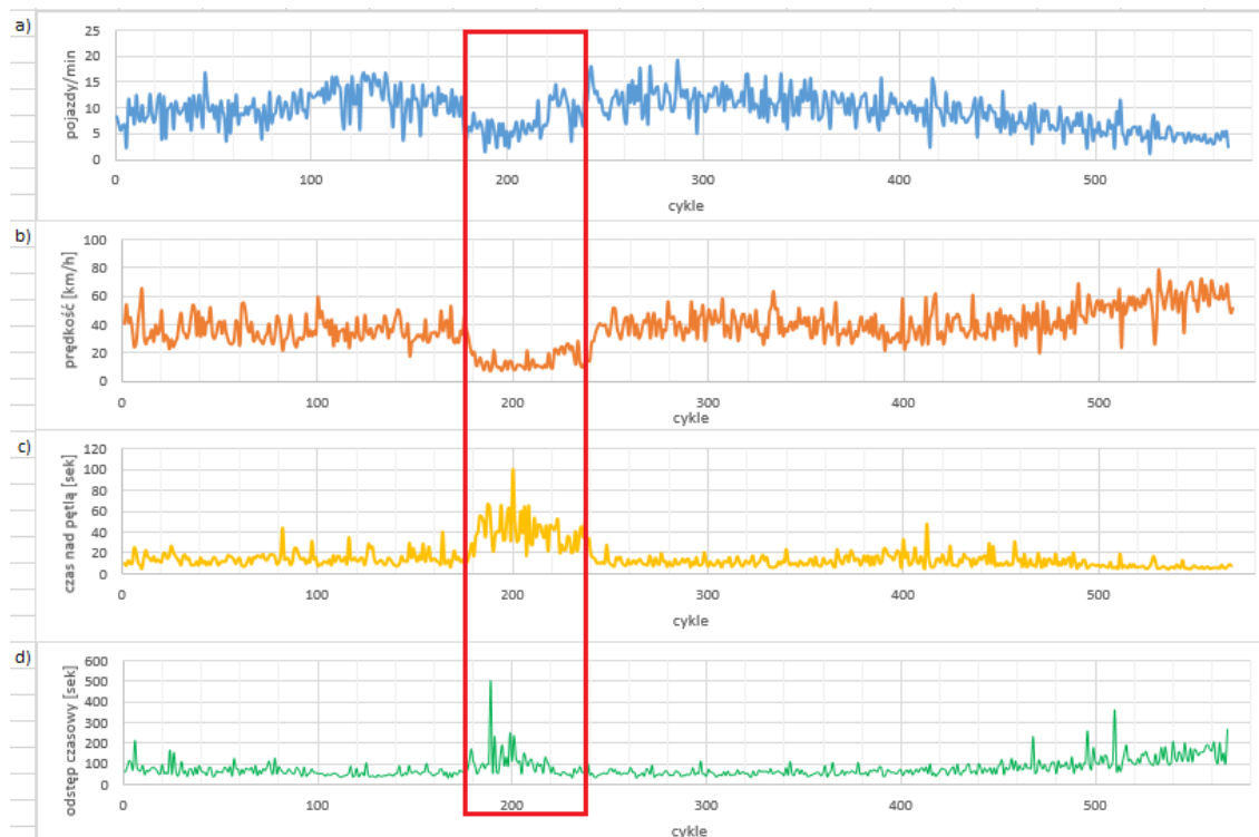
Rysunek 36. Odczyty z pętli nr 5 w dniu 24.07.2014 wraz z oznaczonym momentem incydentu:
