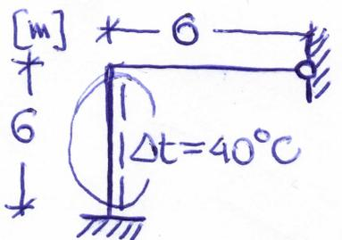
$EI = 10^4 \text{ kNm}^2$   $\alpha_t = 10^{-5} \text{ } ^\circ\text{C}^{-1}$   $h = 0,4 \text{ m}$
