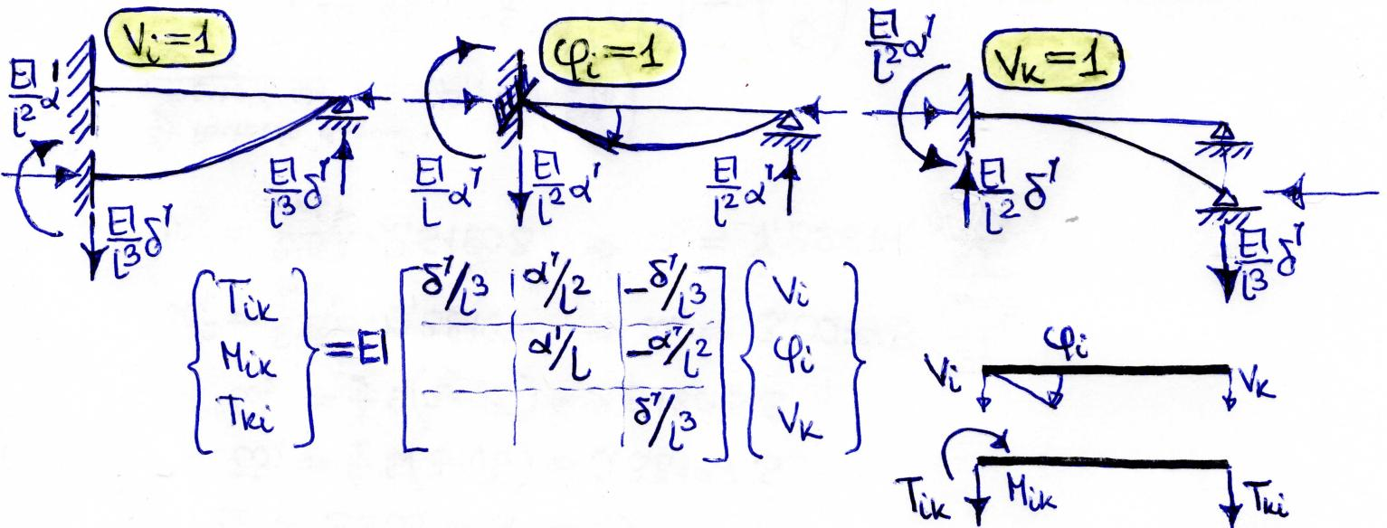
$\alpha, \beta, \vartheta, \delta$  oder  $\alpha', \delta' \rightarrow$  funktige Parameter.  $\lambda = \sqrt{\frac{P l^2}{E I}}$
