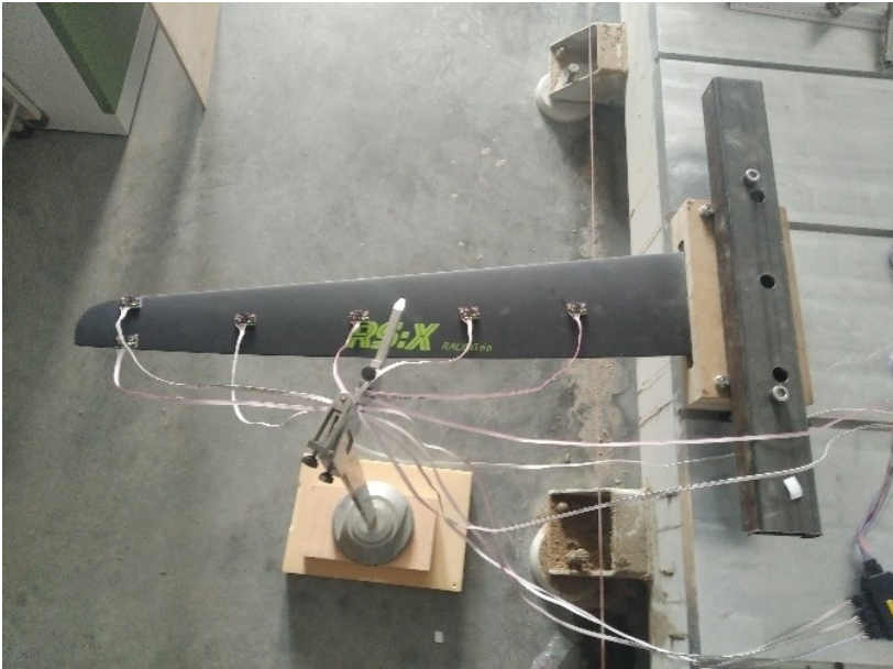
Rys. 4. Stanowisko do pomiarów oscylacji płata. [H. Pruszko 2021]
