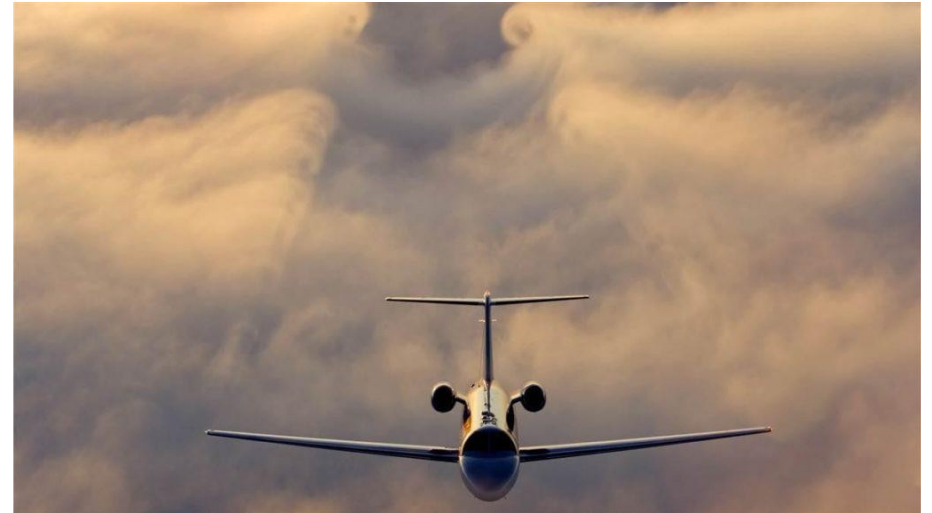
Rys. Zmiana pędu powietrza ( downwash ) na skutek przelatującego samolotu. Zdjęcie zjawiska [https://www.aviatest.eu/2020/04/08/the-word-of-the-week-downwash/]
