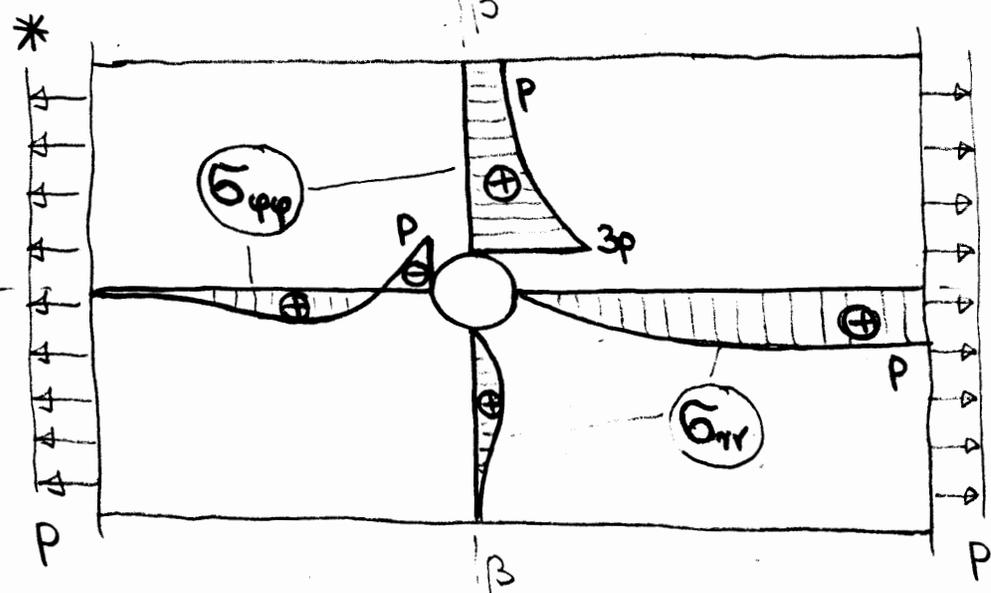
rozciągnięta tarcza z otworem (problem koncentracji naprężeń)
