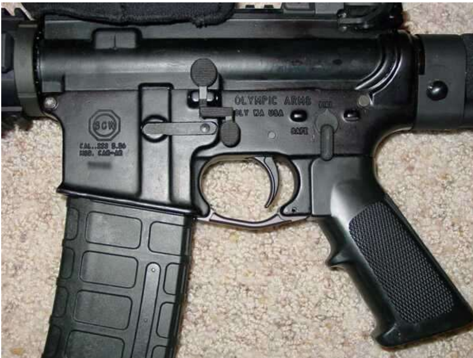
Współczesny wyrób wielkoseryjny – obróbka plastyczna i podzespoły z tworzywa
