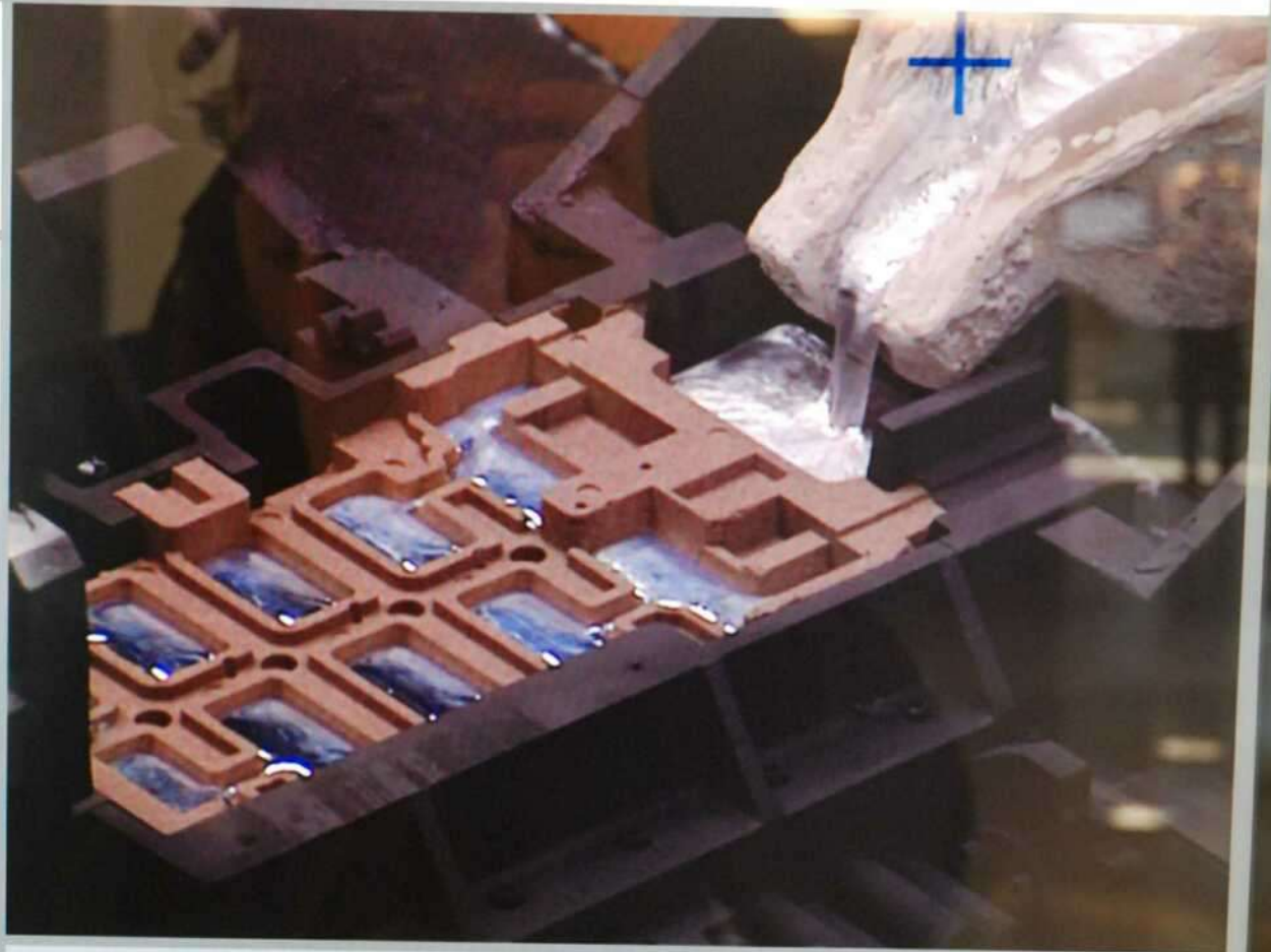
Kokillenguss von Zylinderköpfen.
