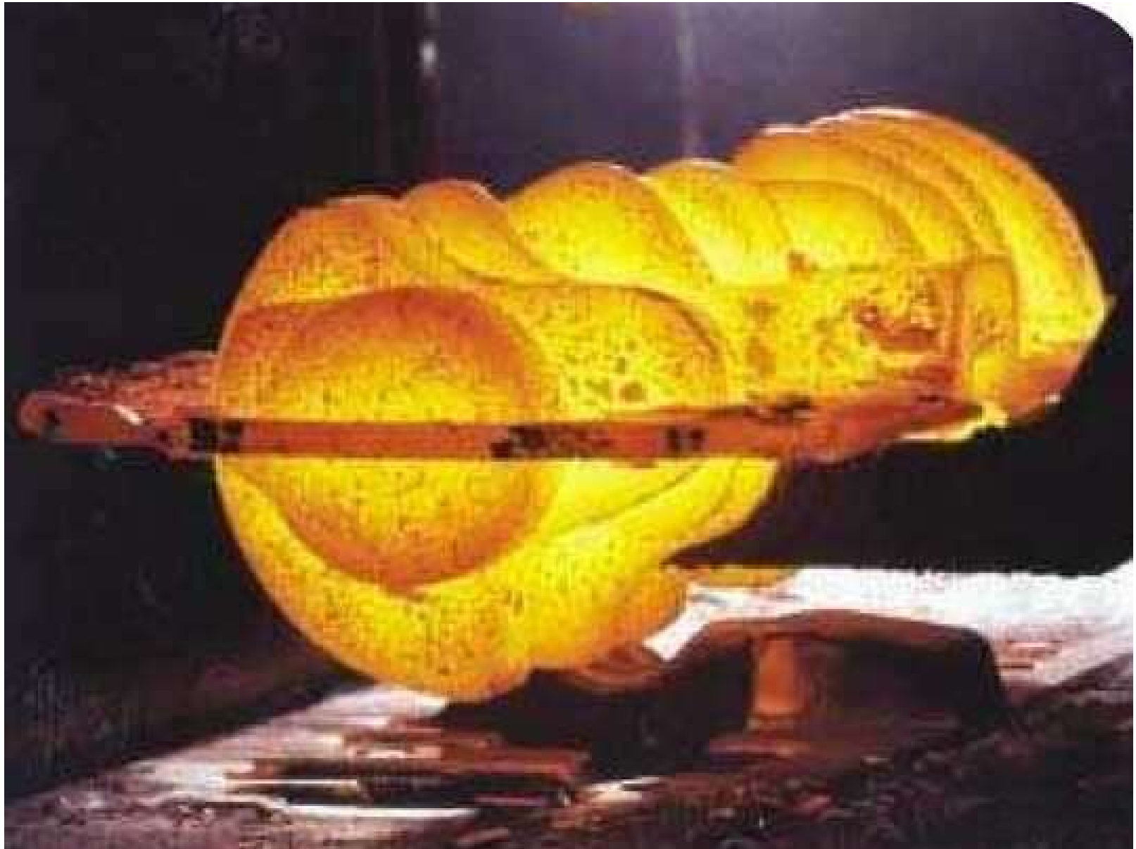
Odkuwanie wału korbowego
