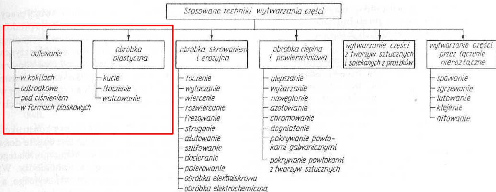
Rys. 2.9. Uproszczony wykaz stosowanych technik wytwarzania
