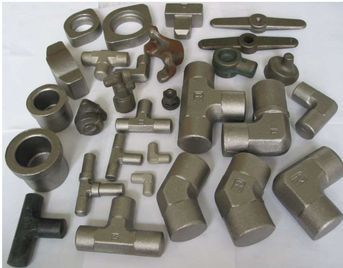
Kute matrycowo prefabrykaty do produkcji złączy ciśnieniowych
