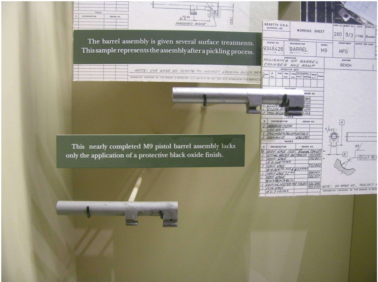
Dalsza obróbka skrawaniem lufy
