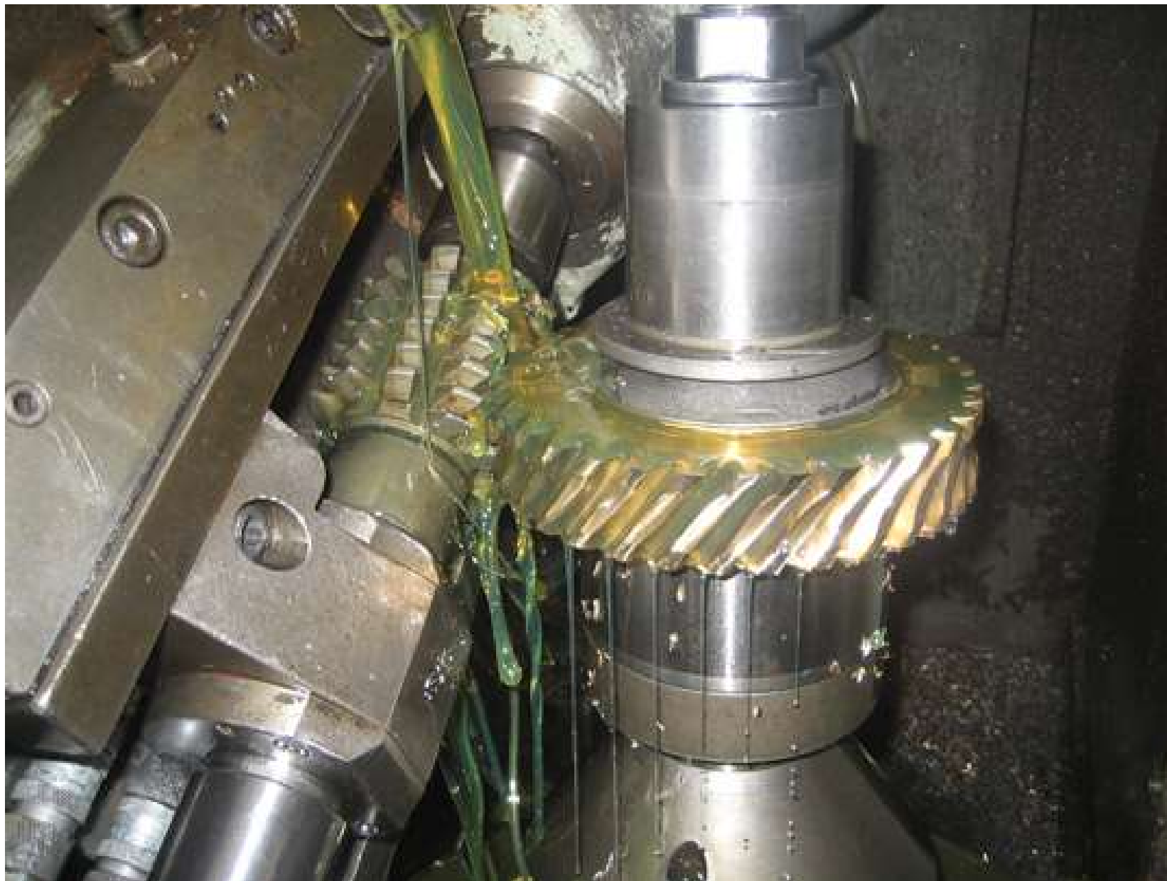
Frezowanie obwiedniowe ślimacznicy przy pomocy frezu ślimakowego
