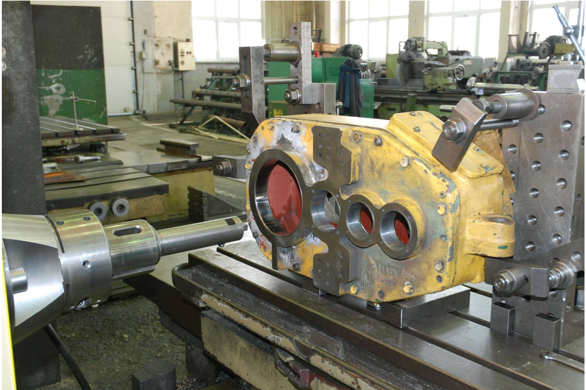
Wytaczanie gniazd łożyskowych w korpusie odlewanym przekładni zębatej
