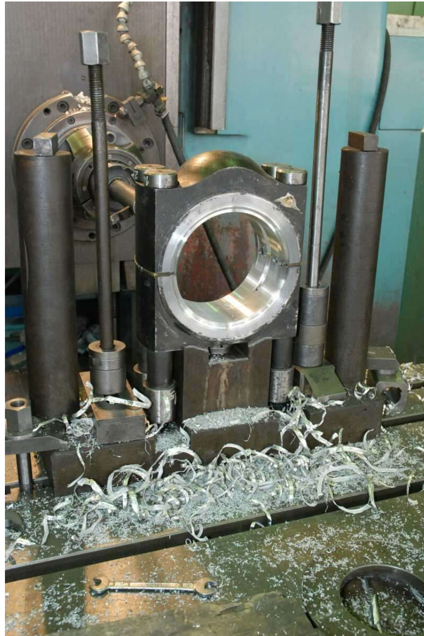
Wytaczanie otworu wewnętrznego łożyska ślizgowego
