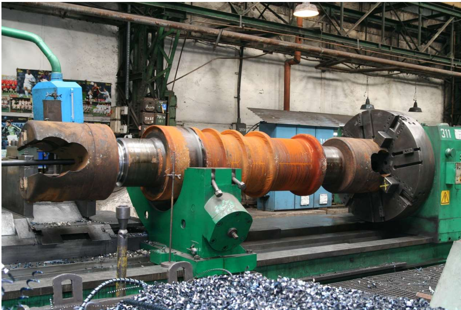
Obróbka skrawaniem – toczenie odkuwki wału o znacznej średnicy
