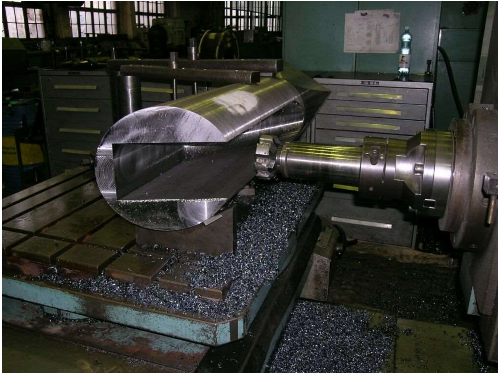
Frezowanie rowka w trzonie sterowym
