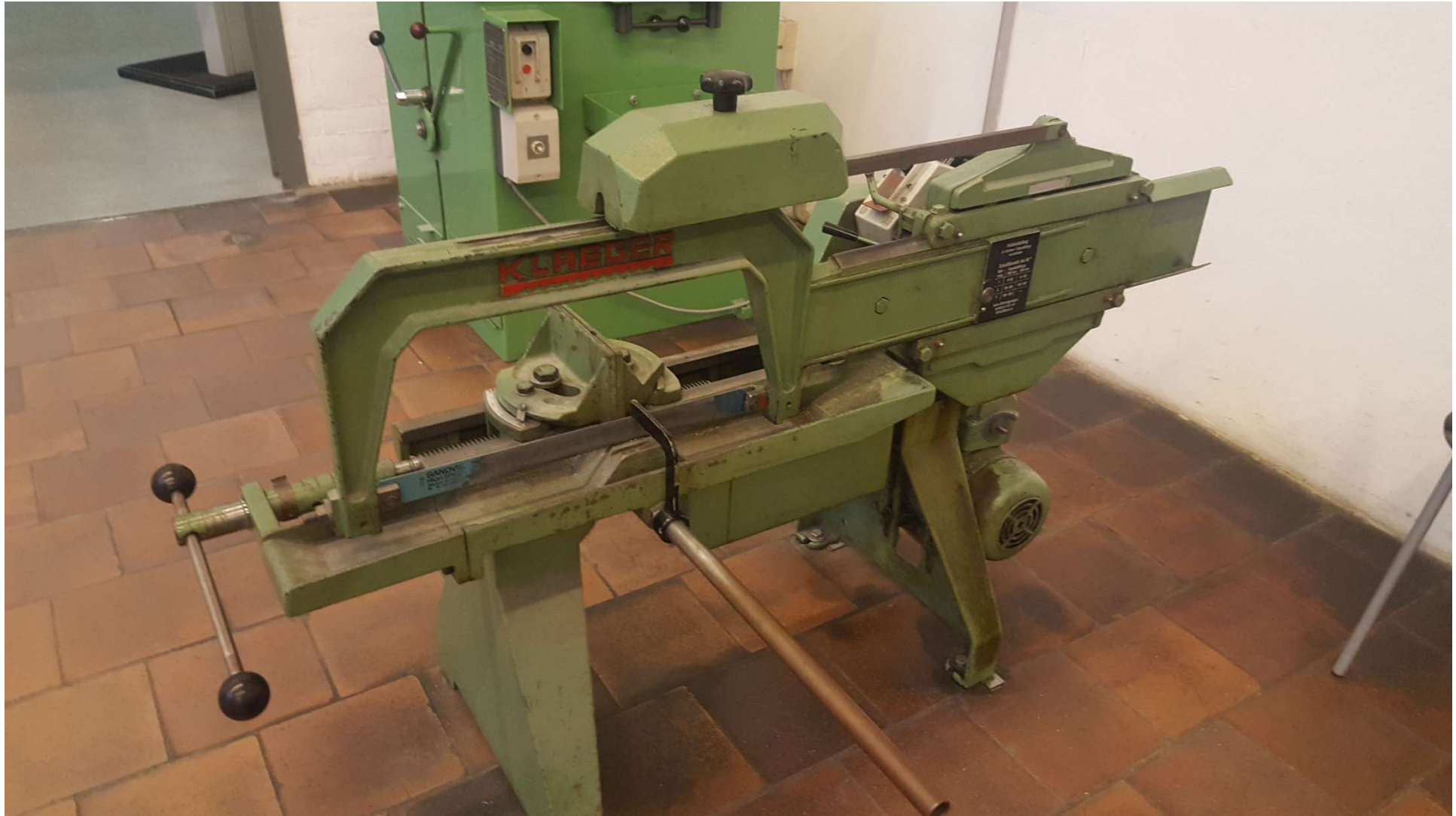
Piła ramowa z napędem elektrycznym – brzeszczot wykonuje ruch posuwisto - zwrotny
