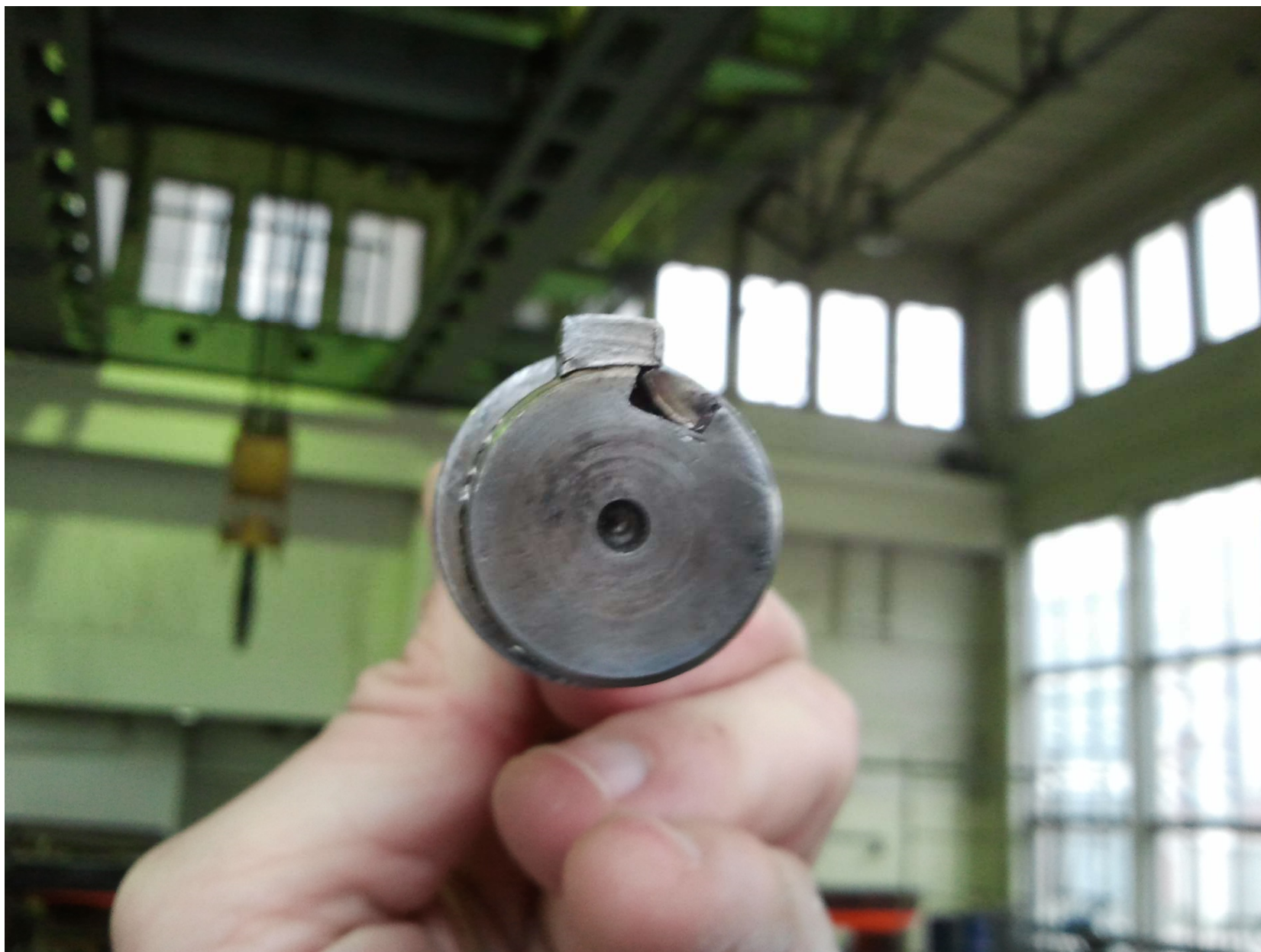
Zniszczone połączenie wpustowe – ścięty wpust
