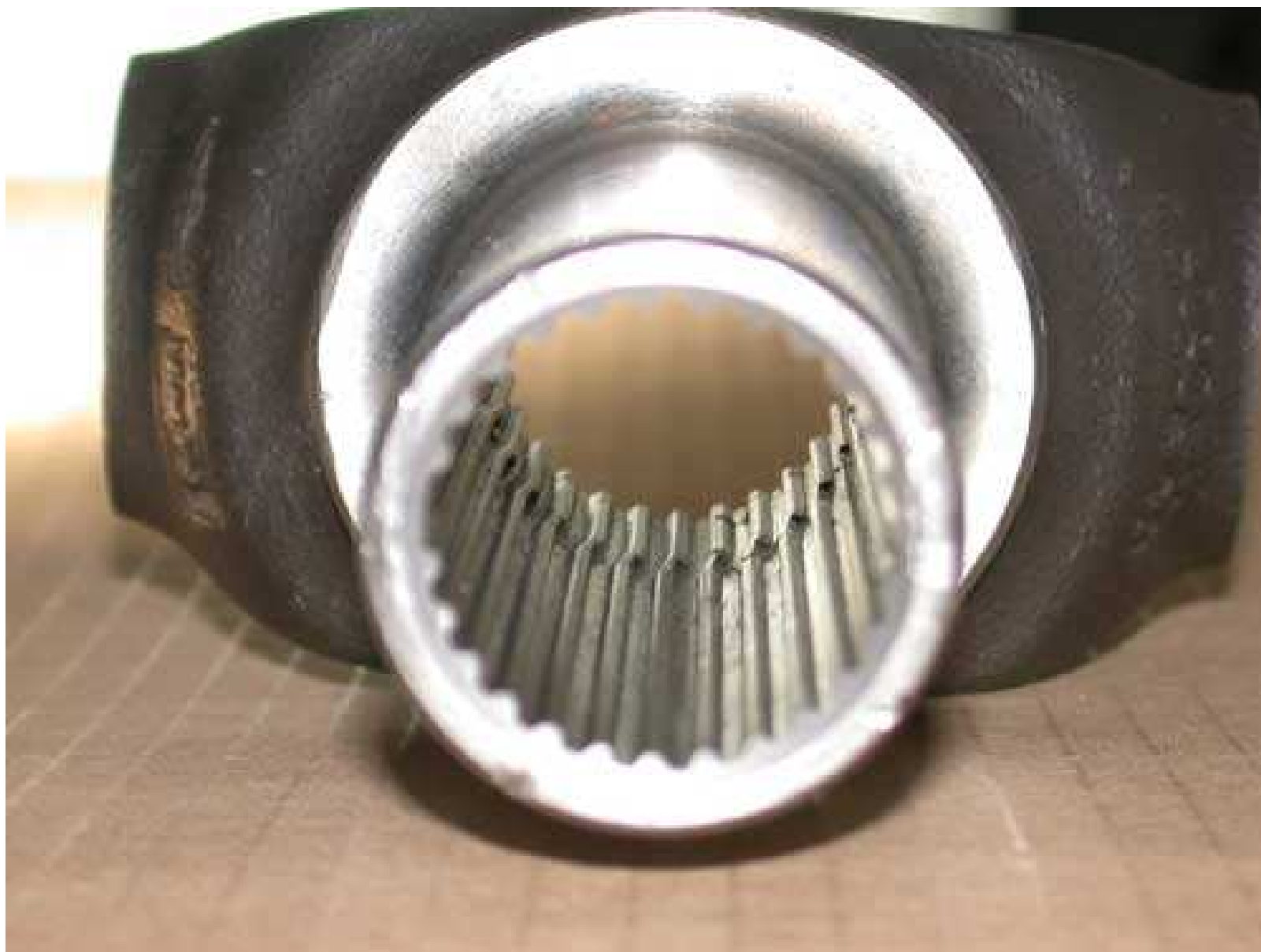
Zdeformowany wielowypust w wyniku przeciążenia momentem obrotowym
