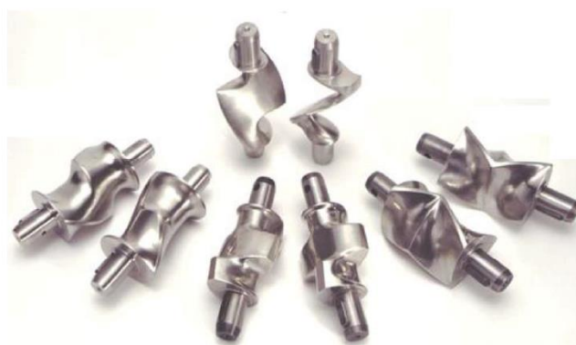
RYS.2. Różne konstrukcje rotorów stosowanych w mieszalnikach zamkniętych [3]
