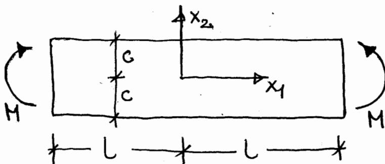
Torze o jednostkowej grubości wymiary  $2L \times 2c$
