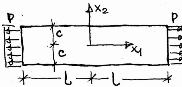
Tarcza o jednostkowej grubości, wymiary  $2l \times 2c$ , dwie rozcięcia równe  $p$
