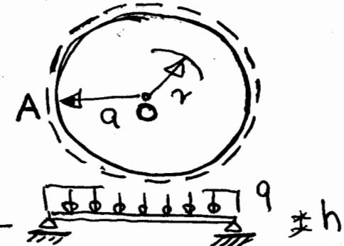
Rozumowanie ogólne:  $W(r) = \frac{qr^4}{64D} + C_1 r^2 \ln r + C_2 r^2 + C_3 \ln r + C_4$
