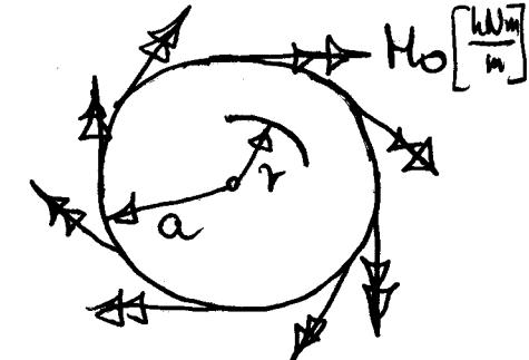
$$W(r) = C_1 r^2 + C_2 \quad (\text{brak obciążenia ciągłego, redukuje wyrazów logarytmicznych - te same warunki ograniczające})$$
