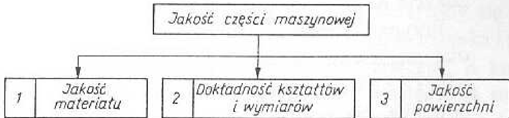
Rys. 3.2. Cechy, od których zależy jakość części maszynowej
